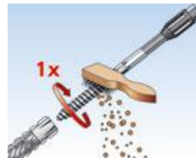
3. Stockschraube reinigen. Kunststoffdübel ca. 1 Umdrehung auf Stockschraube drehen.
